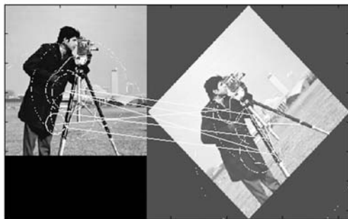
图 9 匹配结果(两幅图像间旋转角度为 45°,并具有 50 个灰度级的亮度变化)
